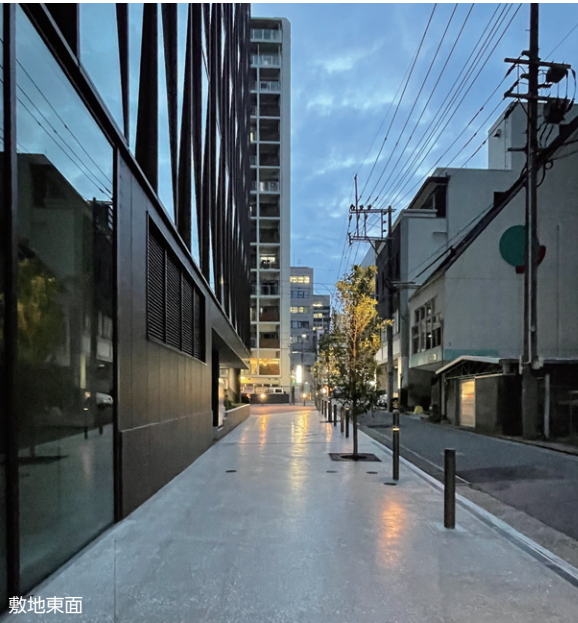
この場所も植栽用のスポットライトと足元の明るさを確保するグレアレスタイプのユニットを組み合わせることでシンプルな形状にすることができるマルチローボールが採用されている。
