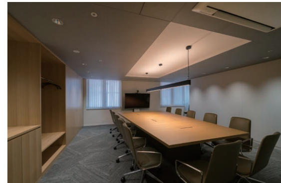
2F グレアレスダウンライトで構成された会議室。机上面の照度がしっかりと確保されるとともに、天井面・壁面に明るさ感がとられている。
