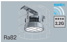
ERG5404SA RB474SA RB475S (指定色塗装・白) (色温度加工) ○ナチュラルホワイト(4000K) 18300lm 159.6W 無線調光タイプ 灯体10.1kg IP20 周囲環境温度5℃～35℃
