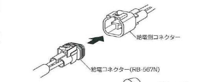
7. 接続したコネクターを全て本体に押し込み、付属の給電側エンドキャップを本体に合わせ、付属の固定ネジで確実に固定してください。
