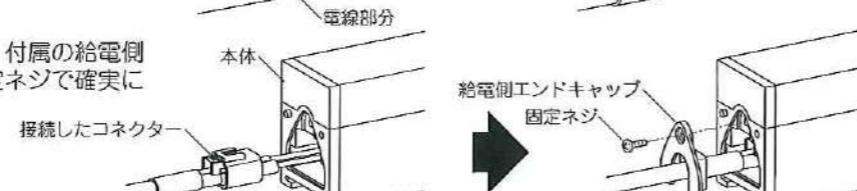
8. 送り側コネクターに付属の送り側エンドキャップを確実に差し込み、付属の送り側エンドキャップを本体に合わせ、付属の固定ネジで確実に固定してください。
