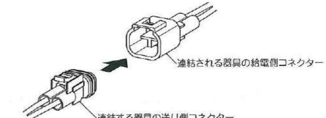
3. 接続したコネクターを全て器具内に押し込みながら、連結する器具に連結される器具を合わせ、連結される器具を付属の取付ネジで確実に取付けてください。
