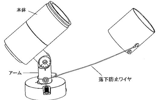
2. オプションフードの取付ネジの位置と本体のフード取付溝を合わせてください。取付ネジを確実に締め込み固定してください。
