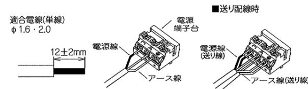
△ 電源線は解除ボタンを押さずに引き抜かないでください。接点金具が変形し、焼損、漏電、感電、不点灯の原因となります。
