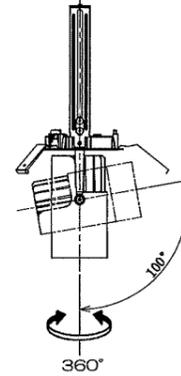
△ 指定範囲以外可動させないでください。破損・落下・感電の原因となります。
