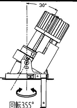
※水平回転は灯具を鉛直 $0^{\circ}$ に立ててから回転させると
