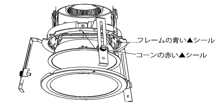
9. 枠カバーの赤い▲シールと枠の赤い▲シールを合わせて、枠の突起が枠カバーの穴に入るまで(約15度)時計回りに回転させてください。
