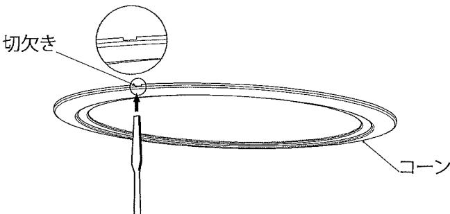
※ 本体を取り外す際は、切欠きにマイナスドライバー(別途)を挿入し、本体を取り外してください。
