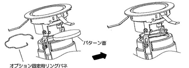
4. コーンを元の位置に戻してください。両側のビスを確実に締め付けてください。
