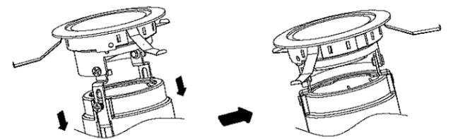
※ オプションの取付は必ず図のようにコーンが上側に向けた状態で作業を行ってください。その他の向きでの作業は、作業時にオプションが落下する原因となります。
