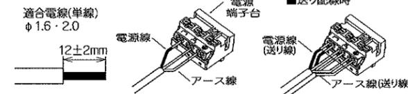
⚠ 電源線は解除ボタンを押さずに引き抜かないでください。接点金具が変形し、焼損、漏電、感電、不点灯の原因となります。
