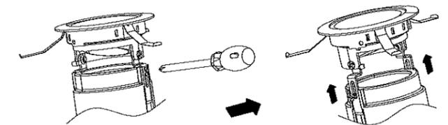
3. オプション固定用のリングバネを取り外してください。オプションを本体内側にある前面パネルまで落とし込み、オプション固定用のリングバネの先端を指で摘んで、本体のリングバネの溝に嵌め込んでください。オプションレンズのパターン面は光源側に向けてください。取付方向にご注意下さい。
