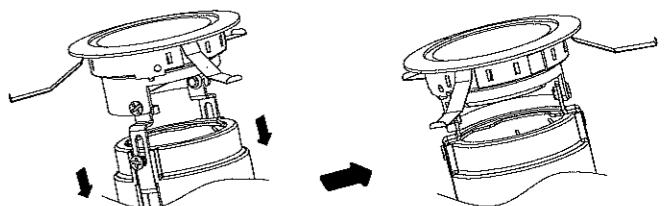
※ オプションの取付けは必ず図のようにコーンが上側に向いた状態で作業を行ってください。その他の向きでの作業は、作業時にオプションが落下する原因となります。
