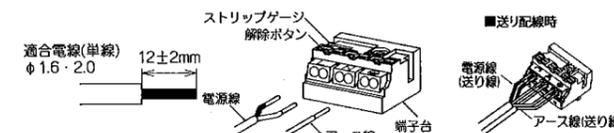
△ 電源線は解除ボタンを押さずに引き抜かないでください。接点金具が変形し、焼損、漏電、感電、不点灯の原因となります。
