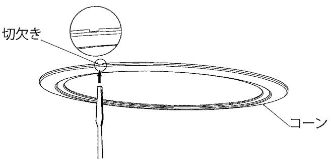
\* 本体を取り外す際は、切欠きにマイナスドライバー(別途)を挿入し、本体を取り外してください。
