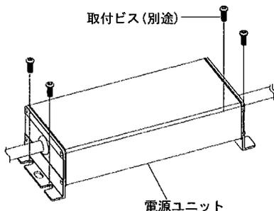
3. 電源ユニットを取付ビスで確実に取付けてください。※取付ビスは別途ご用意ください。
