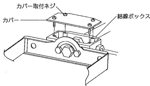
△ 取付けが不完全ですと、浸水による漏電・器具故障の原因となります。
