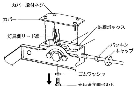
△ 締め付けが不完全ですと、浸水による漏電・器具故障の原因となります。
