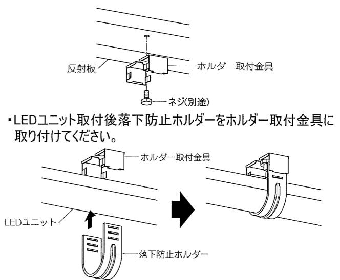
△ 接続不完全や取り付け方向が反対の場合は、火災・感電・器具故障の原因となります。
