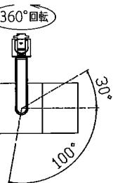
△ 指定範囲以外可動させないでください。破損・落下・感電の原因となります。
