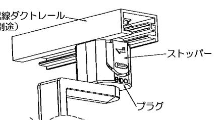
△ 取付けが不十分な場合、落下・火災・漏電の原因になります。
