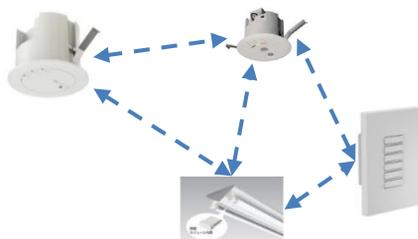
無線モジュール（照明器具、ゲートウェイ、センサー、リモコン）間の通信に使用します。
