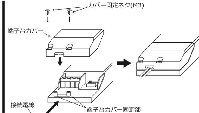
※端子台カバーで接続電線を固定したあと、接続電線が容易に外れないか確認してください。
