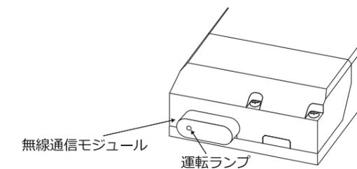
●電波を利用した通信のため、金属製の壁、コンクリート壁などからできる限り遠ざけて設置してください。
