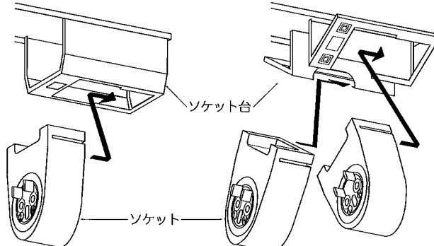
※取付けの際、可動式と固定式が向かうように取付けてください。
