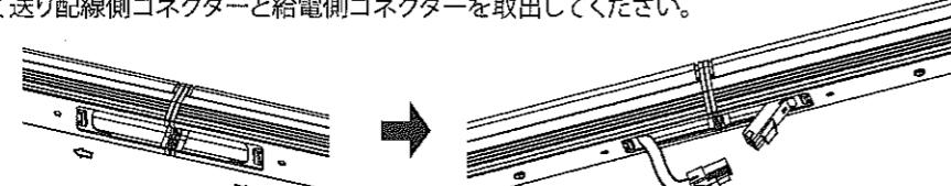
2. 送り配線側コネクターと給電側コネクターを確実に接続してください。接続したコネクターは送られる側の器具内に収めてください。
