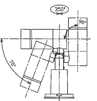
△ 指定範囲以外可動させないでください。破損・落下・感電の原因となります。
