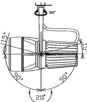
△ 指定範囲以外可動させないでください。破損・落下・感電の原因となります。
