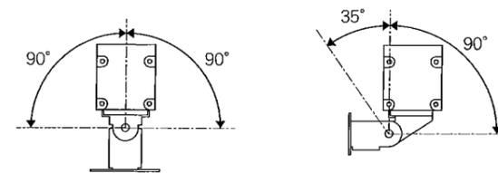
△ 指定範囲以外可動させないでください。破損・落下・感電の原因となります。
