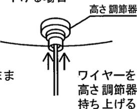
※点灯させたまま、ワイヤーでの高さ調節は絶対にさけてください。安全確保の為、電源(ブレーカー又は壁スイッチ)を遮断してください。
