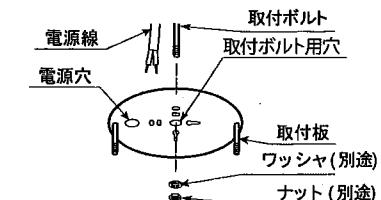
4. 電源線に電源線保護チューブを通し端子台に接続してください。
