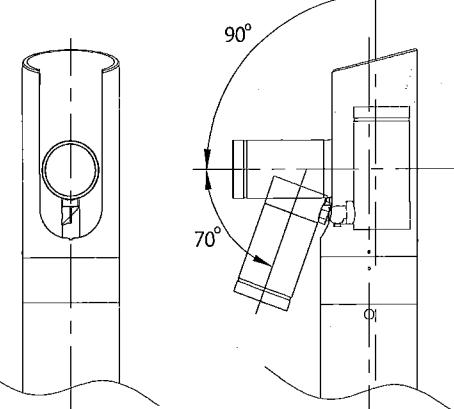
△ 指定範囲以外可動させないでください。破損・落下・感電の原因となります。
