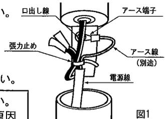
11. ホルダーをポールに落とし込んで、灯具固定ネジで確実に固定してください。
