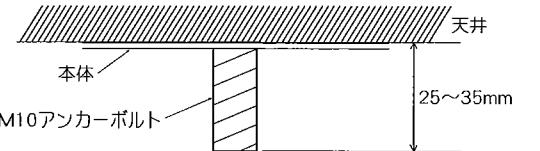
△ 取付部の強度が不十分な場合、器具落下の原因となります。
