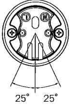
△ LEDユニットに無理な力がかからないように回転させてください。LEDユニット破損の原因となります。
