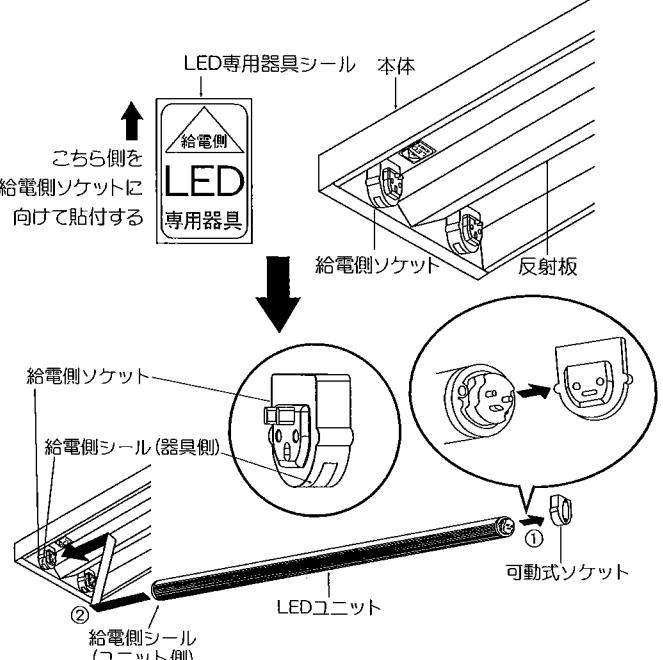
△ 接続不完全や取付け方向が反対の場合、火災・感電・器具故障の原因となります。
