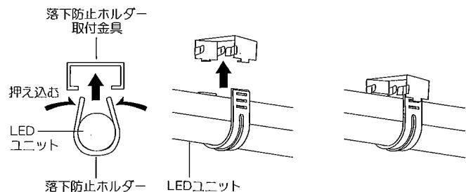
△ 接続不完全や取付け方向が反対の場合、火災・感電・器具故障の原因となります。
