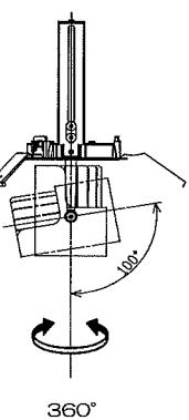
△ 指定範囲以外可動させないでください。破損・落下・感電の原因となります。
