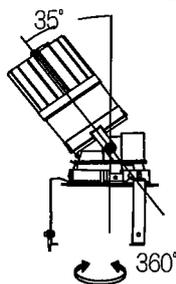
⚠ 指定範囲以外可動させないでください。破損・落下・感電の原因となります。
