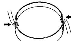
6. 黒リングが器具の中心にくるように置いてヒートシンクの溝とコーンの突起がきちんとはめ込み、フード固定ビスを締めてください。
