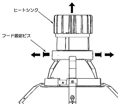
△ 光源(LED)に直接触れないでください。故障の原因となります。
