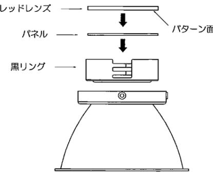
スプレッドレンズの筋と垂直方向に光が伸びます。取付方向にご注意下さい。
