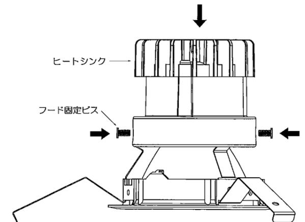
ヒートシンクを取り付ける際はヒートシンクの溝とコーンの突起がきちんとはまるようにして取り付けして下さい。
