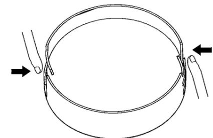
6. ヒートシンクをフードに取り付けて矢印の方向に回してください。黒リングが器具の中心にくるように置いてフード固定ビスを締めてください。
