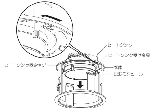
4. ツマミを押しながらヒートシンク側コネクタをLEDモジュール側コネクタから引き抜いてください。
