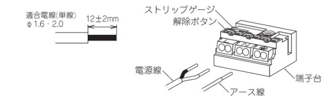
△ 電源線は解除ボタンを押さずに引き抜かないでください。接点金具が変形し、焼損、漏電、感電、不点灯の原因となります。
