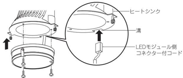
7. ヒートシンク側コネクタにLEDモジュール側コネクタを確実に差し込み接続してください。
