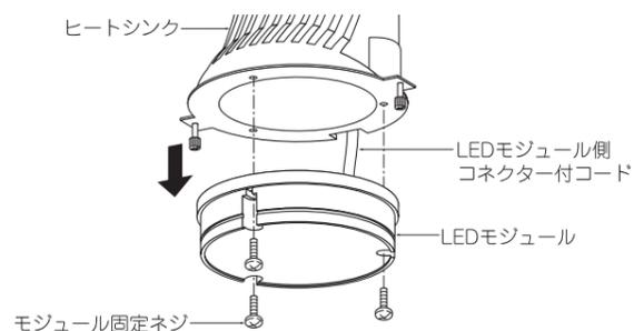
6. 新しいLEDモジュールのLEDモジュール側コネクタ付コードをヒートシンクの溝に合わせてから、LEDモジュールをヒートシンクに合わせて、LEDモジュール固定ネジ(3個)を締め付けて固定してください。
