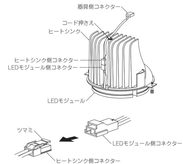
5. モジュール固定ネジ(3個)をゆるめて、LEDモジュールをヒートシンクから取りはずし、LEDモジュール側コネクタ付コードをヒートシンクから引き抜いてください。
