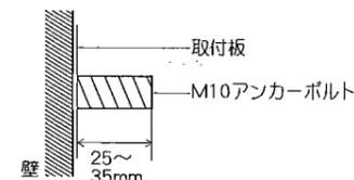
△ 取付部の強度が不十分な場合、器具落下・火災・感電・器具故障の原因となります。
