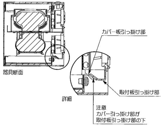
7. カバーと取付板をビスで工具にて確実に取付けてください。
