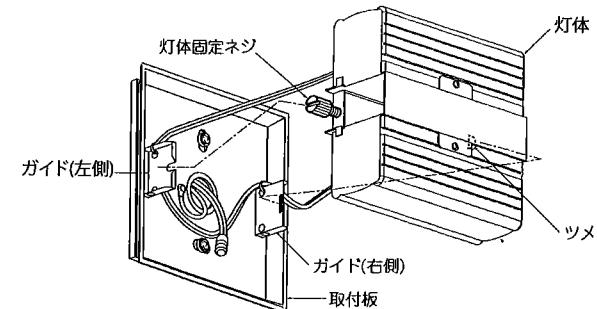
8. カバーを取付板に合わせ、取付面に押し付けながら、ゴムワッシャ(2枚)、平座金(2枚)、カバー取付ネジ(2本)で確実に取付けてください。
