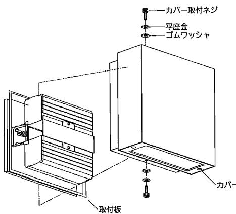
3. 灯体の左側の灯体固定ネジをゆるめ、取付板のガイド(左側)の切り欠きからはずし、灯体の右側のツメを取付板のガイド(右側)から抜いて灯体を取りはずしてください。
