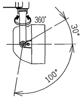
⚠ 指定範囲以外可動させないでください。破損・落下・感電の原因となります。
