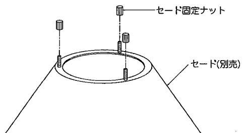
2. セード固定ナット(3個)を灯体のダルマ穴に合わせて、セードを左に回して、セード固定ナット(3個)を確実に締め付けて固定してください。
