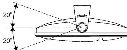
△ 指定範囲以外可動させないでください。破損・落下・感電の原因となります。
