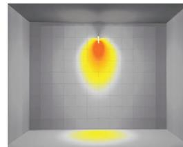
より光を伸ばしつつ、天井際にも照射することで、壁面をよりフラットに照射できます。
