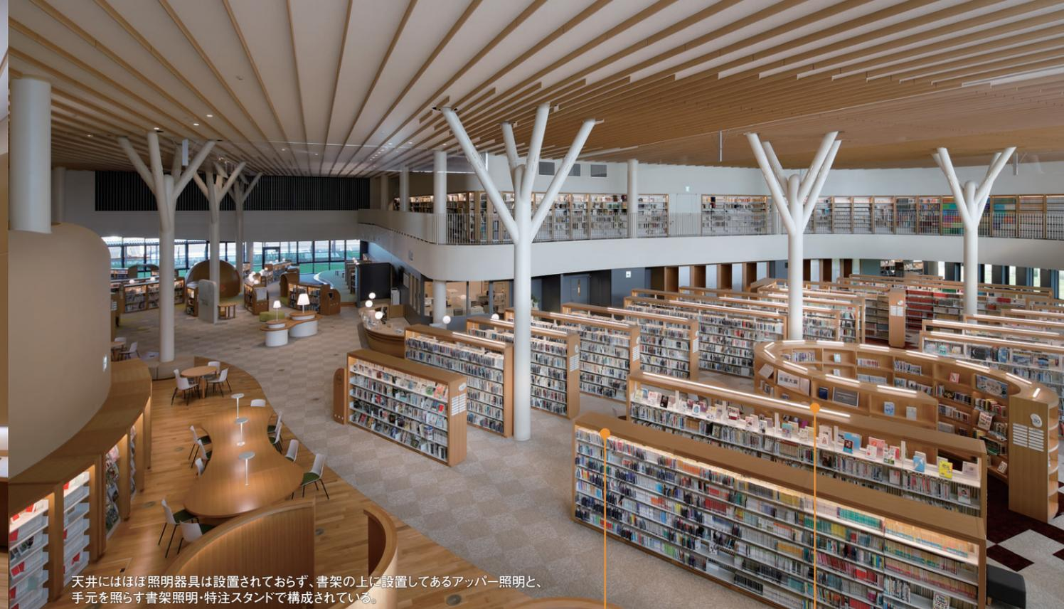
天井にはほぼ照明器具は設置されておらず、書架の上に設置してあるアッパー照明と、手元を照らす書架照明・特注スタンドで構成されている。
