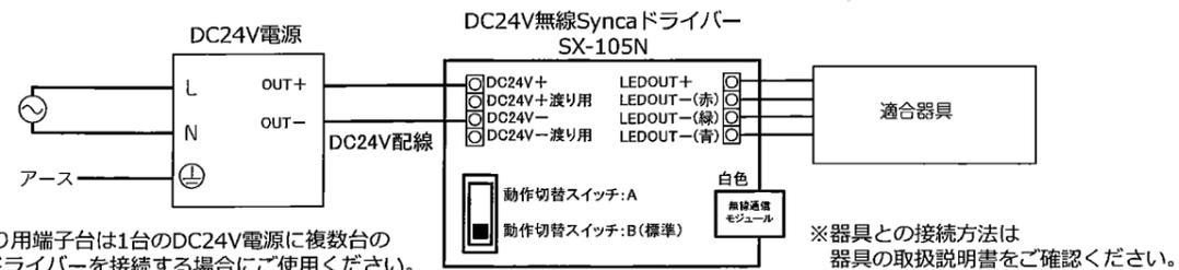
※DC24V渡り用端子台は1台のDC24V電源に複数台の無線制御ドライバーを接続する場合にご使用ください。
