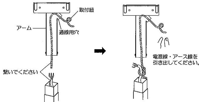
3. アームをポール(別売)に合わせ、付属のM8固定ボルト(4個)で確実に取付けて下さい。
