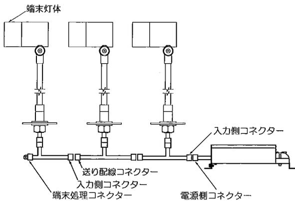
端末灯体の送り配線には端末処理コネクタを確実に差し込み接続してください。
