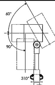
△ 指定範囲以外可動させないでください。破損・落下・感電の原因となります。
