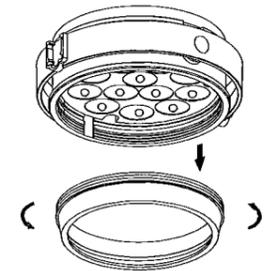
5. モジュール固定ネジ(3個)をゆるめて、LEDモジュールを灯体から外し、LEDモジュール側コネクタ付コードを灯体の結線スペースから引き抜いてください。
