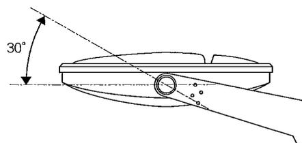
△ 指定範囲以外可動させないでください。破損・落下・感電の原因となります。
