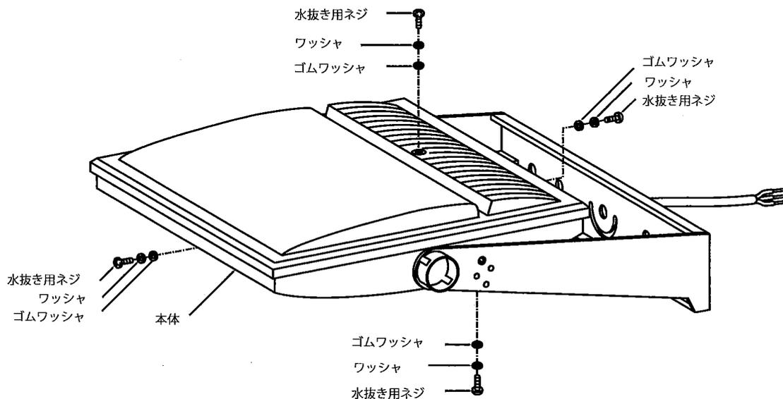
⚠ 水抜き穴を必ず確保してください。漏電・感電・器具故障の原因になります。
