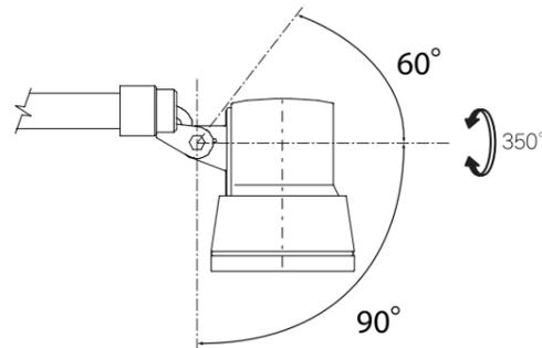
△ 指定範囲以外可動させないでください。破損・落下・感電の原因となります。
