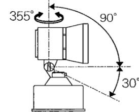
△ 指定範囲以外可動させないでください。破損・落下・感電の原因となります。
