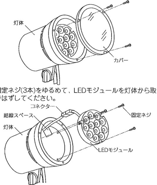
3. 固定ネジ(3本)をゆるめて、LEDモジュールを灯体から取りはずしてください。
