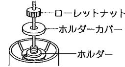
(注)ERP7118Nは、セードをホルダーにのせる際に灯体の下側をセードの下側のフレームに引っ掛けてください。
