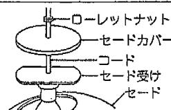
6. セードを少し斜めにしてセード受けにはめ込んでください。セードがはまりましたらセードカバーをのせ、ローレットナットを締めて固定してください。
